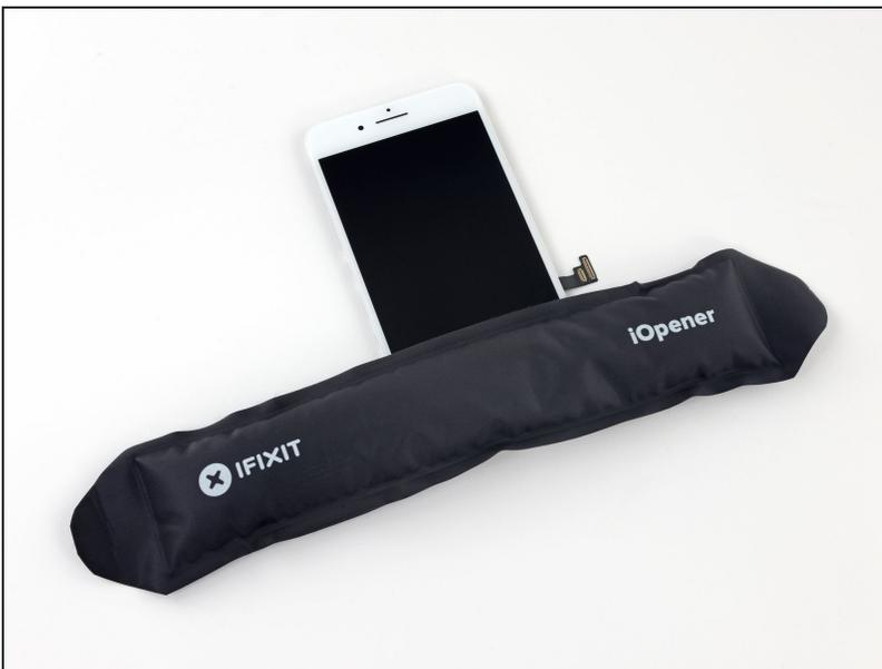
ⓘ Chauffer la zone tout autour du capteur home/Touch ID contribuera à ramollir l'adhésif fixant la nappe fragile de ce capteur. Il sera alors plus facile de la retirer en toute sécurité.
