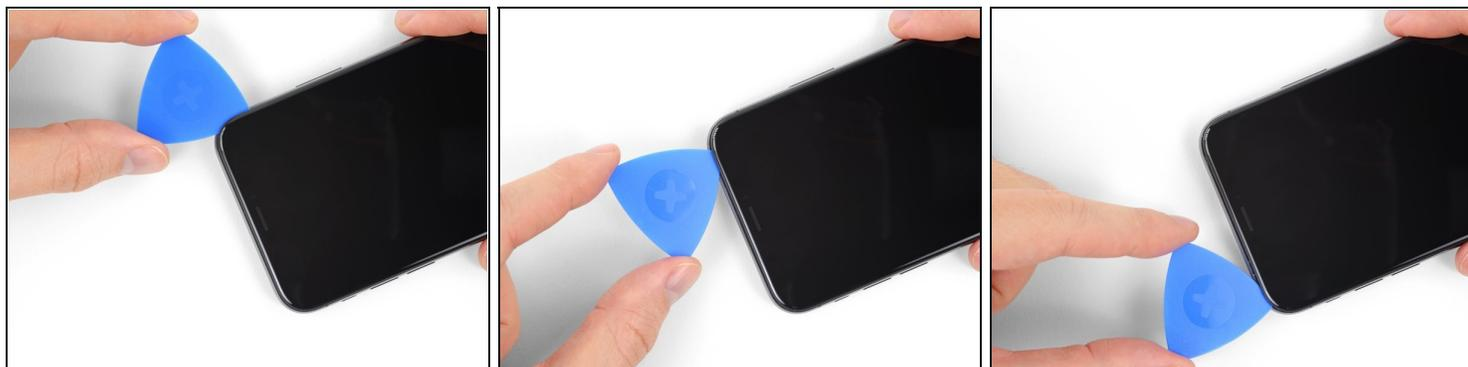
① Le bord supérieur de l'écran est retenu par de la colle et des clips.
