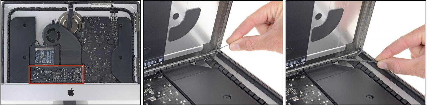
**⚠** Veillez à ne pas toucher les condensateurs ni les soudures apparentes à l'arrière du bloc d'alimentation (encadré en rouge).
