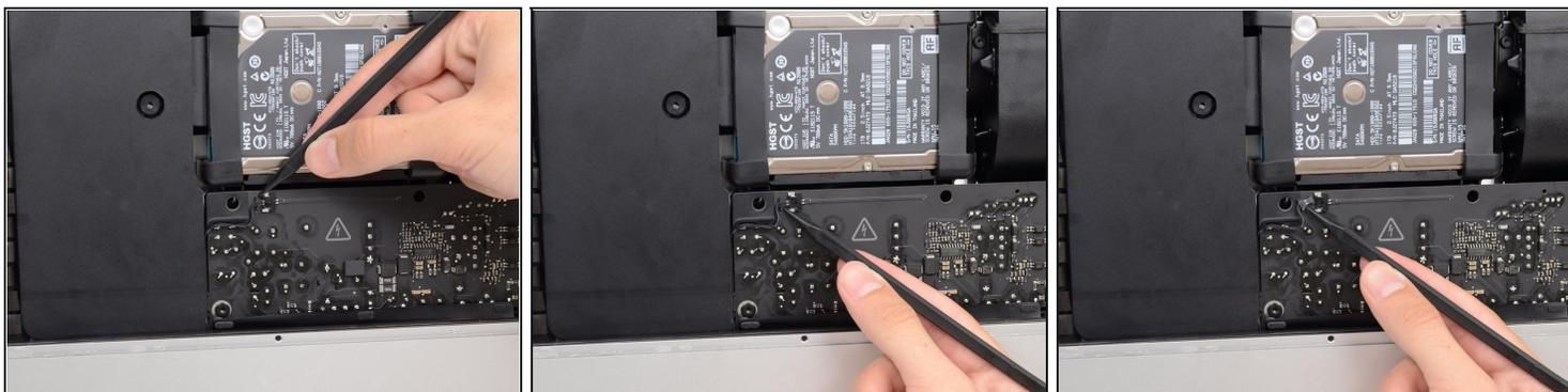
⚠ Les quelques étapes suivantes rapprochent vos mains de la face exposée de l'alimentation. Ne touchez **pas** la face de l'alimentation ou l'une des soudures exposées. Risque de décharge électrique à haute tension depuis les gros condensateurs fixés à la carte.
