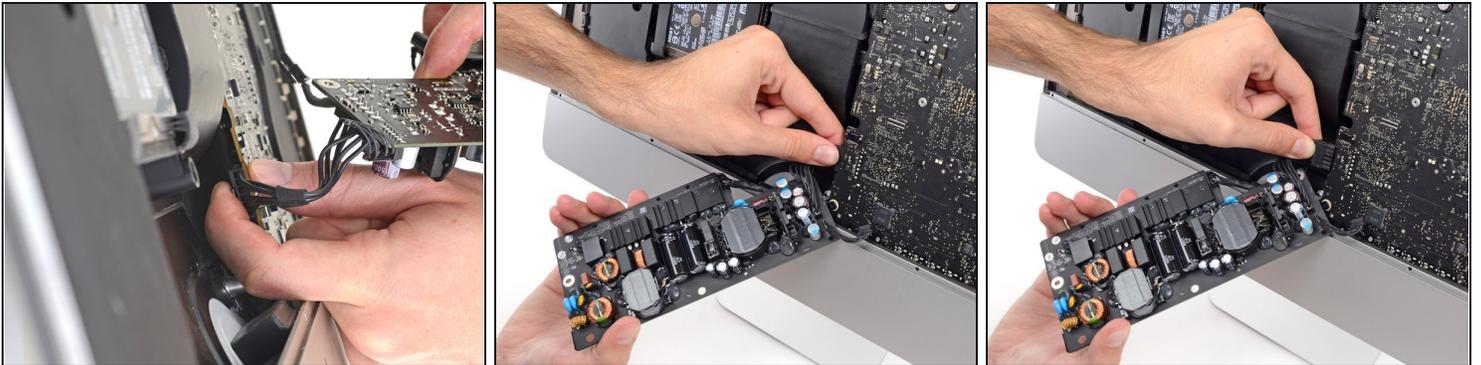
⚠ **Faites très attention** à ne pas toucher les pattes des condensateurs ni les joints de soudure apparents à l'arrière de l'alimentation. Ne la manipulez que par les bords.
