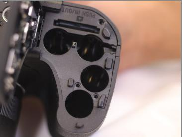
• Placez le pouce sur le couvercle de la batterie et faites-le glisser vers l'extérieur jusqu'à ce qu'il s'ouvre.
