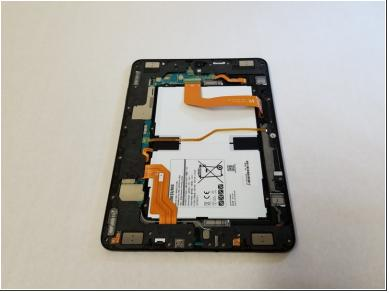
• Répétez les étapes 3 à 7 pour retirer le panneau de verre arrière sur le côté opposé de l'appareil.
