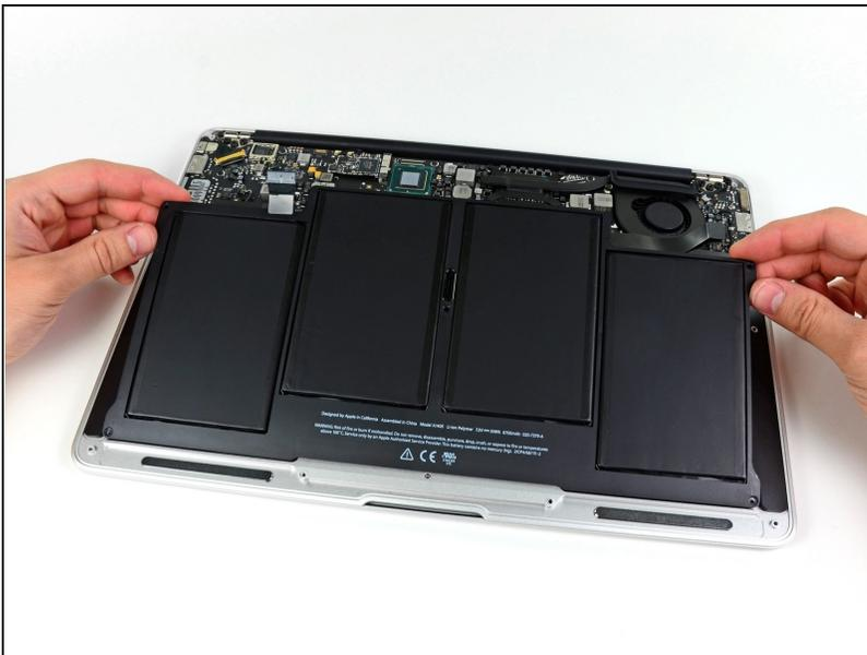
⚠ En manipulant la batterie, évitez d'appuyer ou de toucher les 4 cellules lithium-polymère apparentes.
