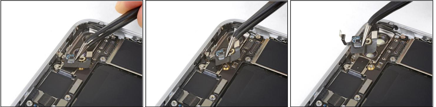
ⓘ L'attache pour vis en haut de la nappe de l'antenne est coincée dans un petit creux du rebord supérieur de l'iPhone.
