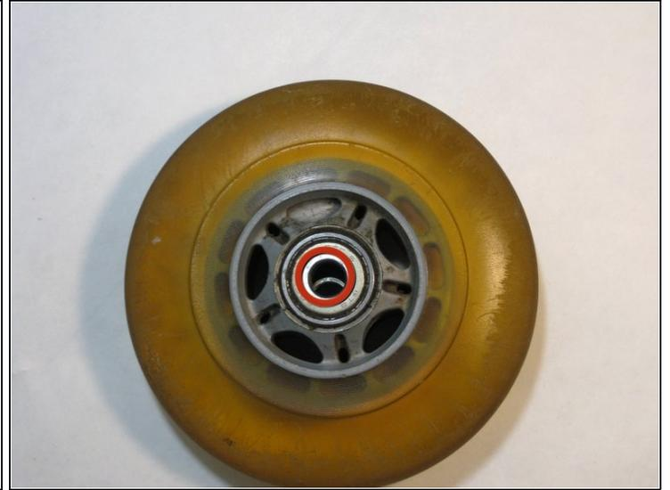
**⚠** Lors du remplacement d'une roue, recherchez un manchon métallique au centre du roulement qui peut être hors ligne. Forcer une vis à travers un manchon qui n'est pas aligné pourrait endommager la roue.
