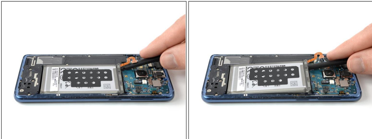
**i** Si vous avez du mal à soulever la batterie, il est possible que l'adhésif n'ait pas assez ramolli. Vous pouvez appliquer quelques gouttes d'alcool isopropylique sous chaque coin de la batterie et laisser pénétrer et agir pendant quelques minutes pour faire ramollir la colle.
