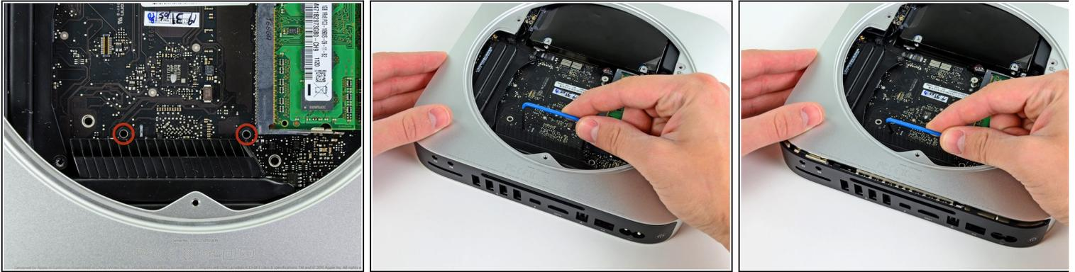
**⚠** Pour le retrait de la carte mère, les deux tiges cylindriques de l'outil de retrait de la carte mère du Mac Mini doivent être insérées dans les orifices repérés en rouge. Attention ! Si vous insérez des instruments dans des orifices de la carte mère autres que ceux repérés en rouge, vous risquez de détruire la carte mère.
