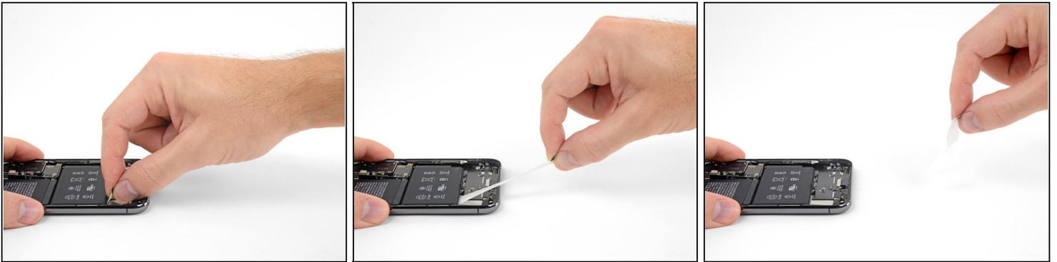
ⓘ Au cours des étapes suivantes, vous allez tirer sur chacune des languettes pour étirer la bande adhésive sous la batterie. Une fois étirées, ces bandes d'extraction spéciales ne collent plus et se détachent manuellement, et vous pouvez retirer facilement la batterie.
