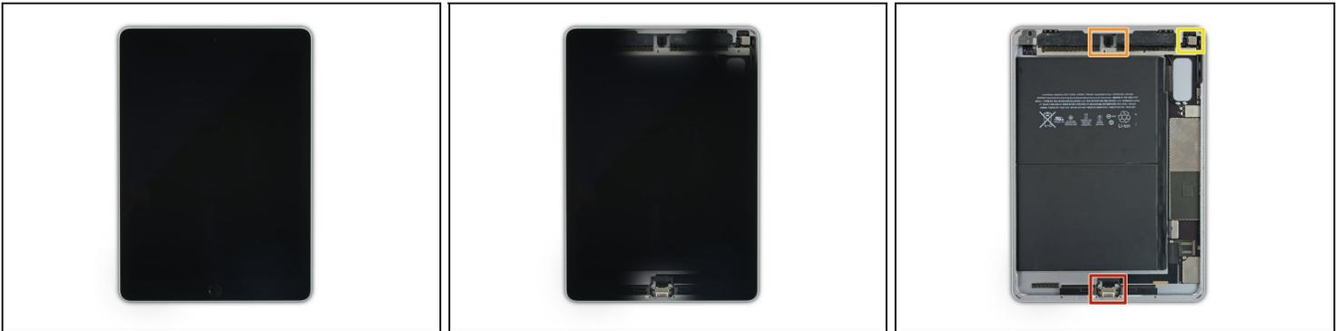
ⓘ Von außen sieht das iPad ganz einheitlich aus, aber es befinden sich empfindliche Komponenten unter bestimmten Bereichen der Frontglasscheibe. Um Schäden zu vermeiden, erhitze und heble das Glas nur an den in den einzelnen Schritten beschriebenen Stellen.
