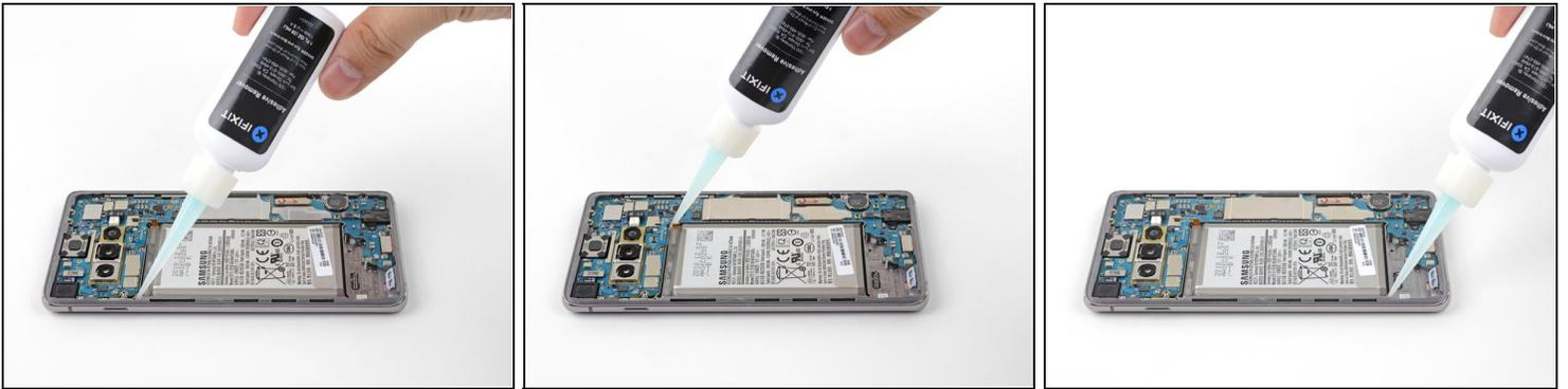
ⓘ L'usage de [dissolvant pour adhésif](#) ou d'alcool isopropylique à haute concentration (de plus de 90 %) peut simplifier énormément le retrait de la batterie.
