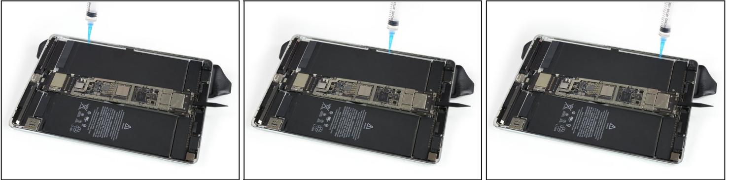
**⚠ N'appliquez aucun solvant sur la nappe du Smart Connector pour éviter qu'elle ne se détache lors du retrait de la batterie.**
