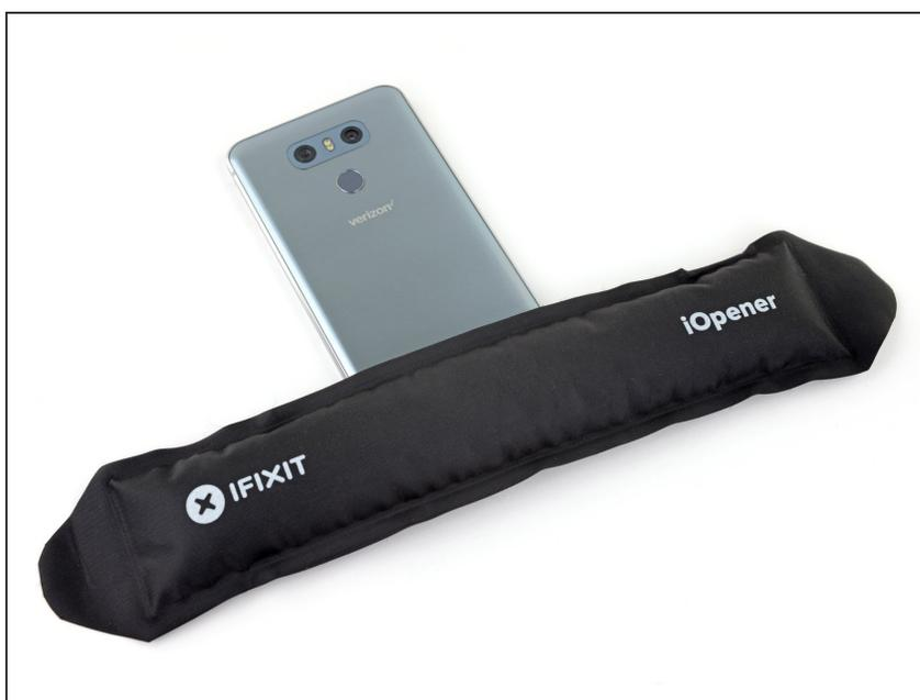
**i** Faire chauffer l'arrière du G6 aide à ramollir l'adhésif qui fixe la coque arrière, et facilite la procédure d'ouverture.
