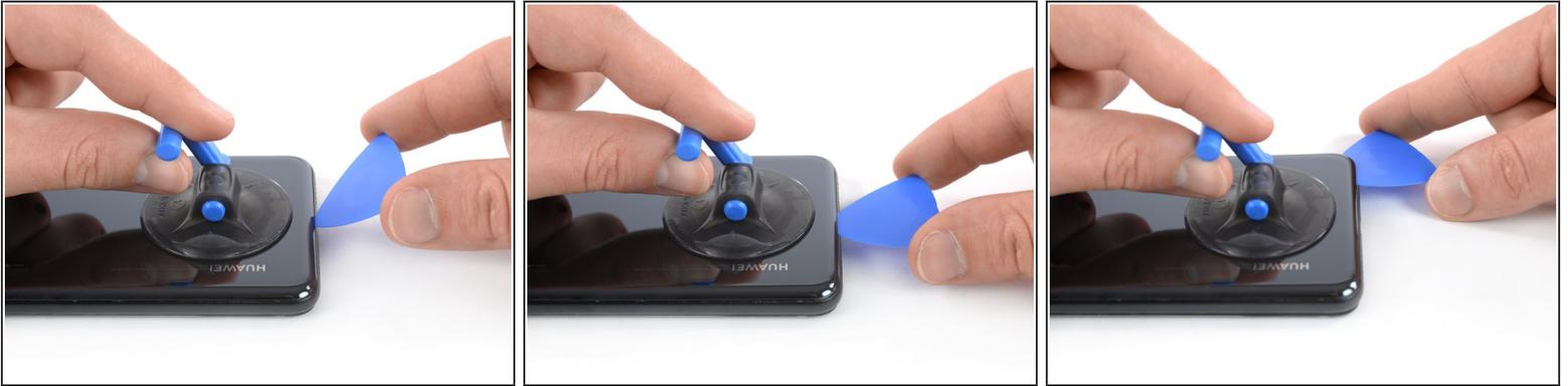
**i** Si la vitre arrière du téléphone est fissurée, la ventouse risque de ne pas adhérer. Essayez de [la soulever avec du ruban adhésif robuste](#). Ou bien collez la ventouse à la vitre avec de la super glue et laissez sécher avant de continuer.
