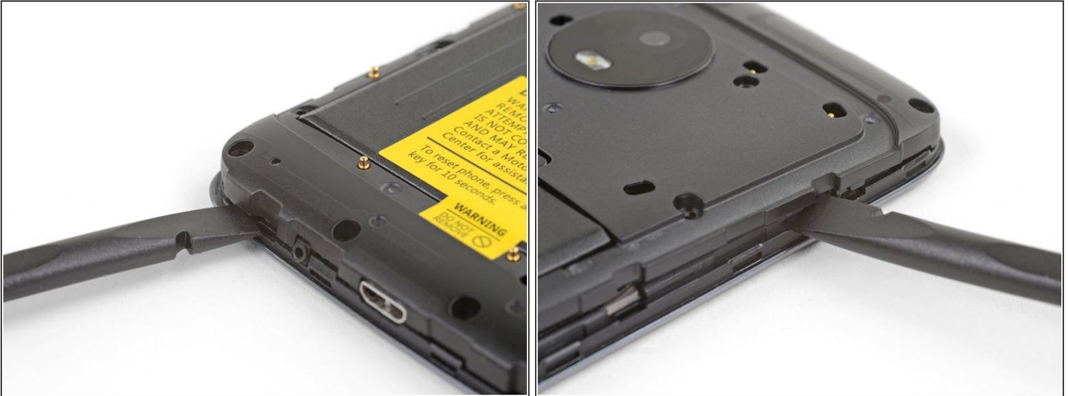
**i** Le châssis central en plastique est maintenu en place par des clips.
