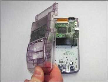
• Soulevez doucement et séparez le boîtier arrière du reste de l'appareil. Vous avez maintenant sorti le boîtier arrière !
