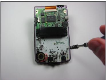
• À l'aide du tournevis cruciforme n° 1, retirez les 3 vis indiquées sur l'image.
