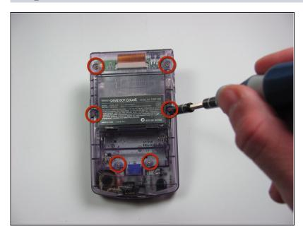
• À l'aide d'un tournevis Y1, retirez les six vis à l'arrière de l'appareil comme illustré. Les deux vis inférieures sont situées à l'intérieur du compartiment à piles.
