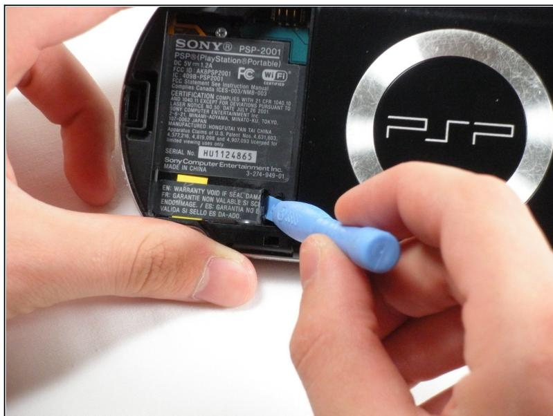
⚠ Cette étape nécessite la suppression de l'autocollant de garantie. **Le retrait de l'autocollant annulera la garantie.** Selon la FTC, cette suppression n'annulera pas votre garantie.
