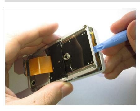
Soulever le couvercle arrière de l'avant du boitier en utilisant un outil d'ouverture en plastique.
