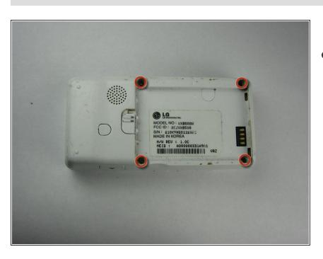
Dévissez les quatre vis Phillips 00 sur les quatre coins sous la batterie pour détacher le boîtier arrière du téléphone.
