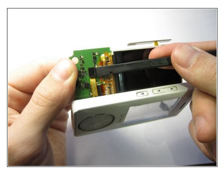
Décrochez le câble ruban en utilisant le côté plat d'un spudger.
