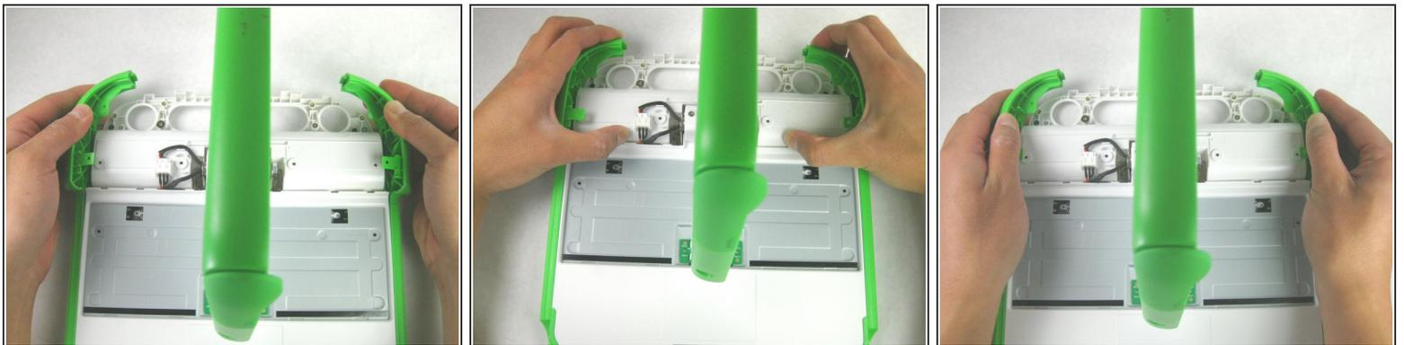
**⚠** Faites attention à ne pas retirer complètement la portion inférieure de l'ordinateur portable, car il y a un câble qui le relie à l'ordinateur portable.
