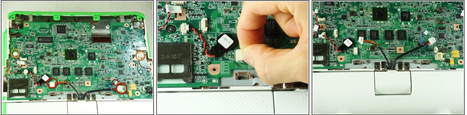
⚠ Débranchez les connecteurs en tirant sur les languettes en plastique et pas sur les fils.
