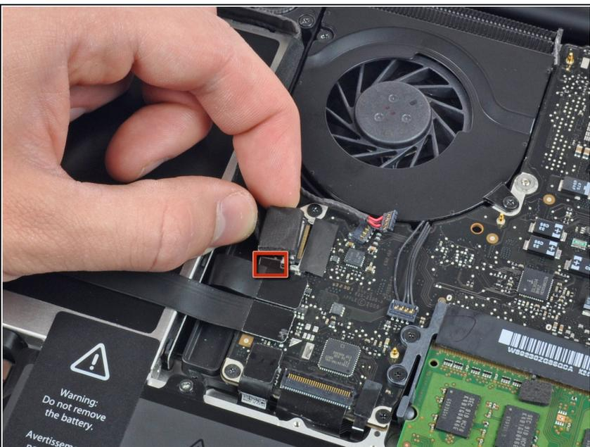
⚠ Il est nécessaire de déplacer le petit clip de fixation du câble en plastique transparent (encadré en rouge) collé sur la carte mère de sorte qu'il ne vous gêne pas pour débrancher le câble vidéo. Lorsque vous l'écartez du connecteur du câble vidéo, faites attention à ne casser aucun des composants sur la carte.
