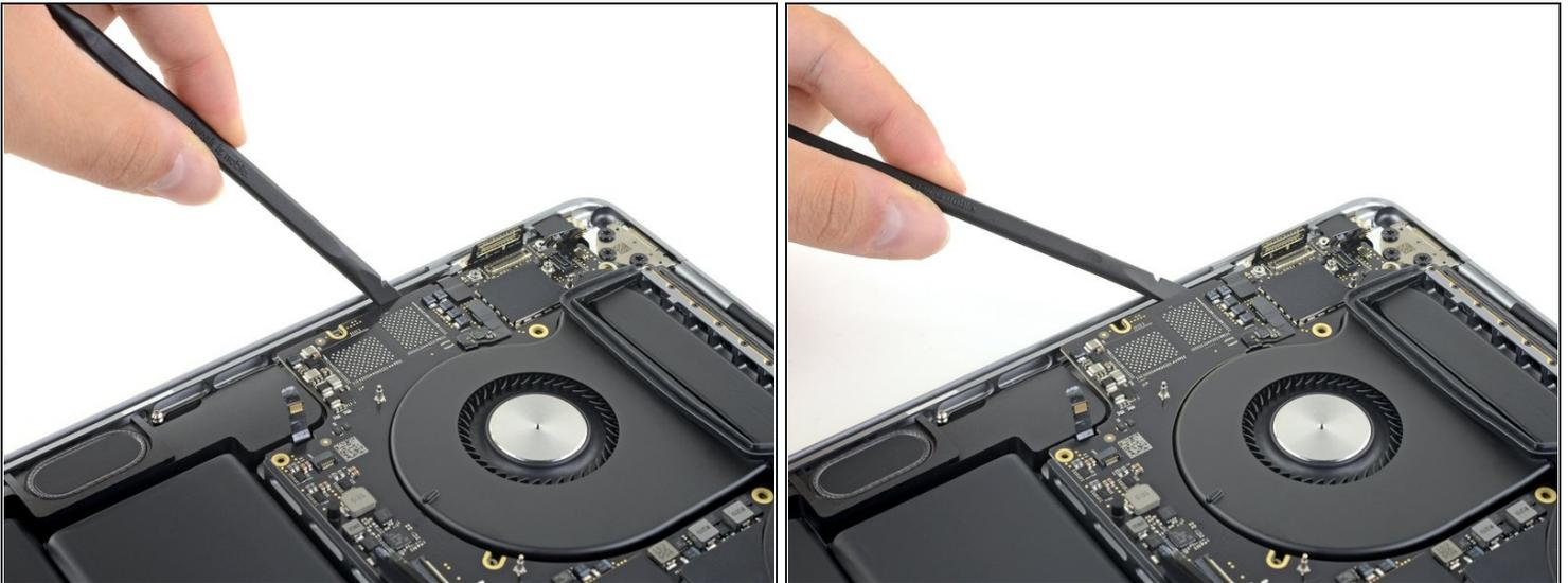
ⓘ La carte mère est solidement encastrée, mais il est plus simple de la retirer en insérant une spatule sous le côté gauche et en faisant **légèrement** levier.
