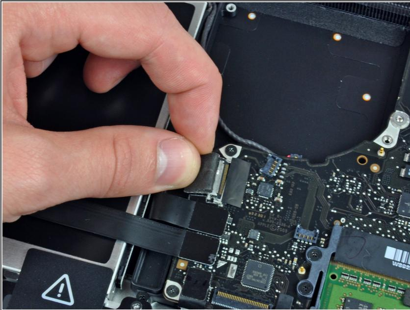
**⚠** Dans cette étape, vous allez déconnecter la nappe de la caméra. La plupart des ordinateurs ont un petit dispositif d'attache autocollant en plastique, fixé à la carte mère pour maintenir le connecteur en place. Avant de déconnecter la nappe, assurez-vous que ce dispositif a été retiré et ne vous gêne pas.
