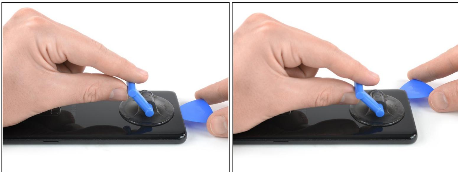
ⓘ Si la vitre arrière du téléphone est fissurée, la ventouse risque de ne pas adhérer. Essayez de [la soulever avec du ruban adhésif robuste](#). Ou bien collez la ventouse à la vitre avec de la super glue et laissez sécher avant de continuer.
