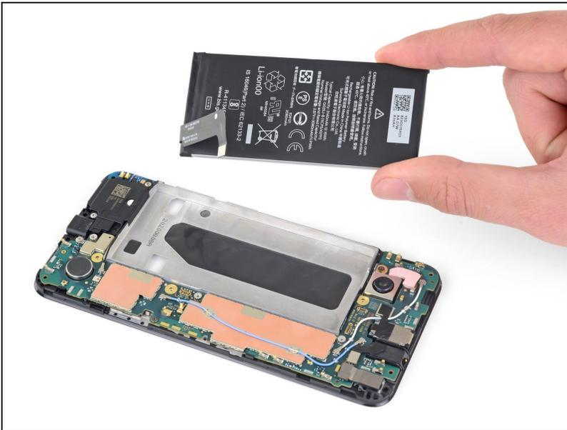
⚠ Ne réutilisez pas la batterie si elle a été déformée ou endommagée, car cela représente un danger. Remplacez-la par une nouvelle batterie.
