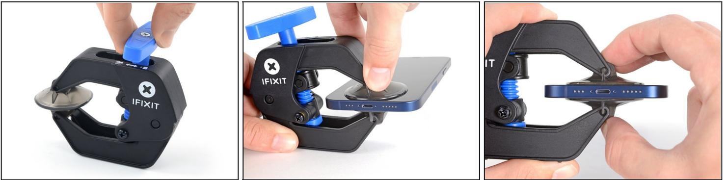
① Les trois étapes suivantes montrent comment utiliser [l'Anti-Clamp](#), un outil conçu pour faciliter la procédure d'ouverture. **Si vous n'utilisez pas l'Anti-Clamp, sautez ces trois étapes pour une autre méthode.**
