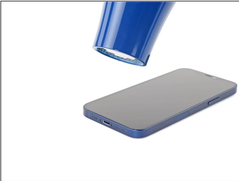
① Utilisez un [sèche-cheveux](#) ou un [pistolet à air chaud](#) pour chauffer le bord de l'iPhone pendant 90 secondes ou jusqu'à ce que l'écran soit légèrement trop chaud au toucher.
