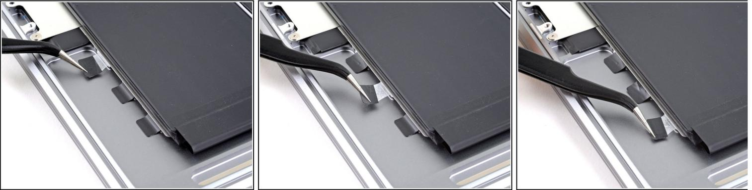
**i** Les cellules de la batterie MacBook Air 13" sont fixées à un châssis métallique et forment un ensemble complet, qui est collé au boîtier avec un total de 6 bandes adhésives étirables.
