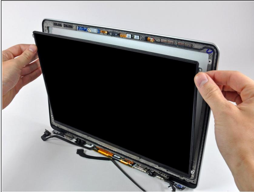
**⚠** N'essayez pas encore de retirer l'écran LCD. Le système de circuits en bas de l'écran est logé dans un interstice le long du bord inférieur du renforcement prévu pour l'écran en aluminium.
