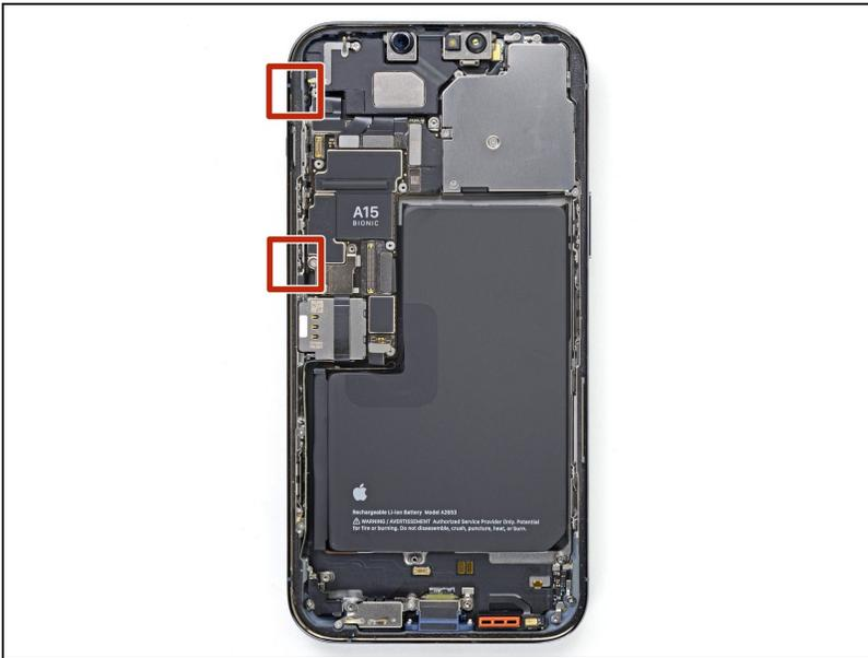
⚠ Il y a des nappes fragiles le long du bord gauche de l'iPhone. **N'insérez pas votre médiateur à cet endroit**, cela pourrait abîmer les nappes.
