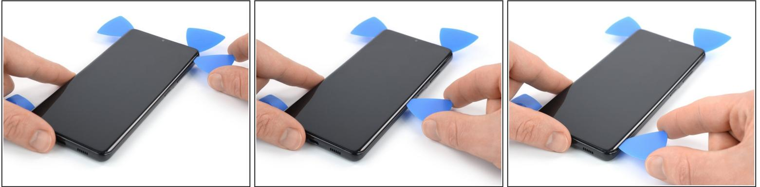
**i** Si l'adhésif devient trop dur pour être tranché, il a probablement refroidi. [Réutilisez l'iOpener](#) ou un pistolet à air chaud pendant 1 à 2 minutes pour le réchauffer.
