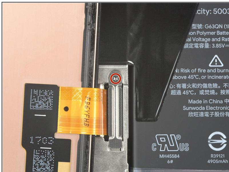
ⓘ Bien que le Pixel 6 Pro utilise des vis Torx Plus, des embouts Torx standard fonctionnent également. Assurez-vous d'appliquer une force constante vers le bas pour éviter de déformer les vis.
