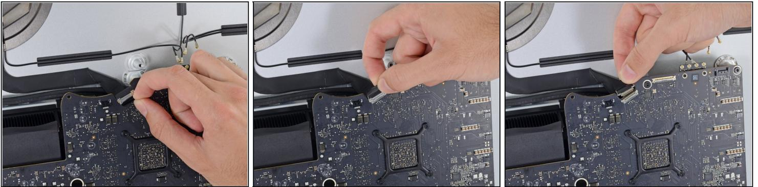
**⚠ Cette connexion est fragile et peut être facilement endommagée.**
