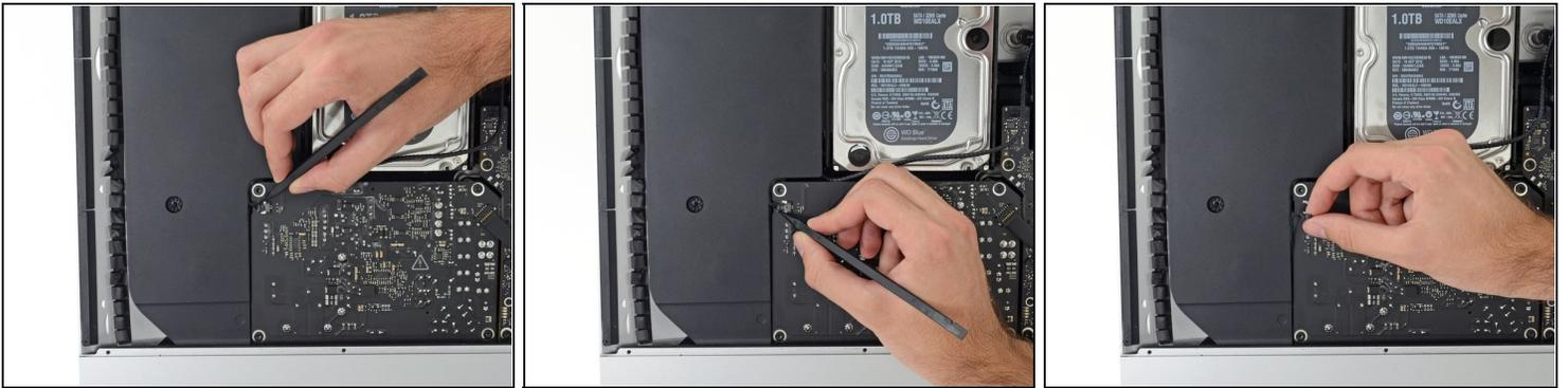
⚠ Veillez à ne pas toucher les soudures à l'arrière du bloc d'alimentation. Les condensateurs peuvent être chargés suffisamment pour provoquer une décharge électrique dangereuse.
