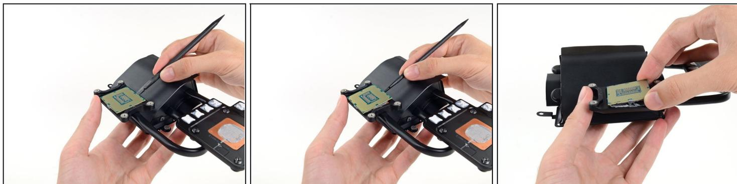
ⓘ Le CPU sera probablement collé au dissipateur thermique avec un composé thermique.
