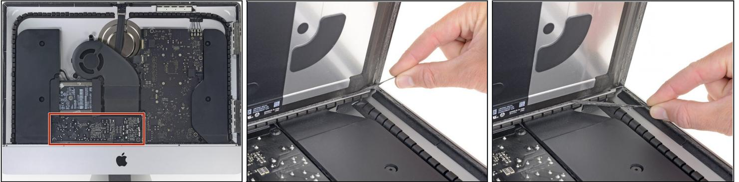
**⚠** Faites très attention à ne pas toucher les pattes des condensateurs ou les soudures apparentes au dos de l'alimentation (dans l'encadré rouge).
