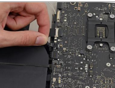
Tirez doucement sur le connecteur du câble du ventilateur pour le débrancher de sa prise sur la carte mère.
