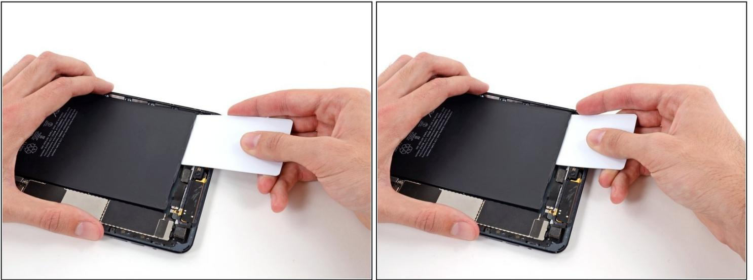
**⚠** Tout au long de la procédure suivante, vous ferez glisser des cartes plastiques fines entre la batterie et la coque arrière de l'iPad, pour séparer l'adhésif de la batterie. Veillez à garder les cartes aussi plates que possible pour éviter de plier la batterie, ce qui pourrait l'endommager et libérer des produits chimiques dangereux.
