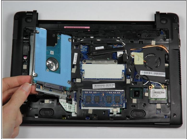
**!** L'ensemble du disque dur est relié à l'ordinateur portable par un câble ruban. Ne soulevez le côté du lecteur en face de vous qu'à environ un pouce au-dessus de l'ordinateur portable. Si vous déchirez le câble ruban, l'ordinateur portable devra être entretenu par un professionnel.
