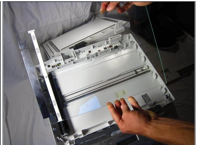
**⚠** Après avoir retiré la plaque, vérifiez qu'il n'y a pas de verre brisé. S'il y a du verre brisé, manipulez-le avec des gants. Le verre brisé, s'il n'est pas manipulé correctement, peut causer des blessures corporelles.
