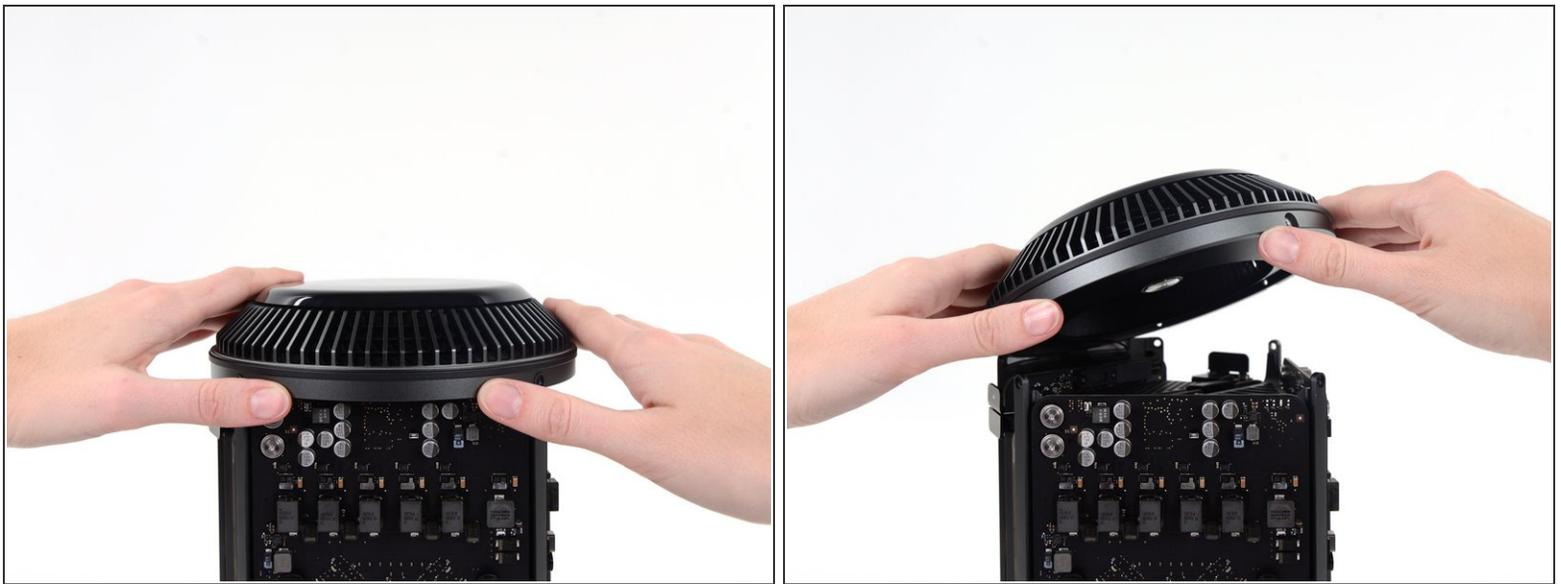
**i** L'ensemble du ventilateur est fixé au reste de l'ordinateur par deux nappes côté E/S.
