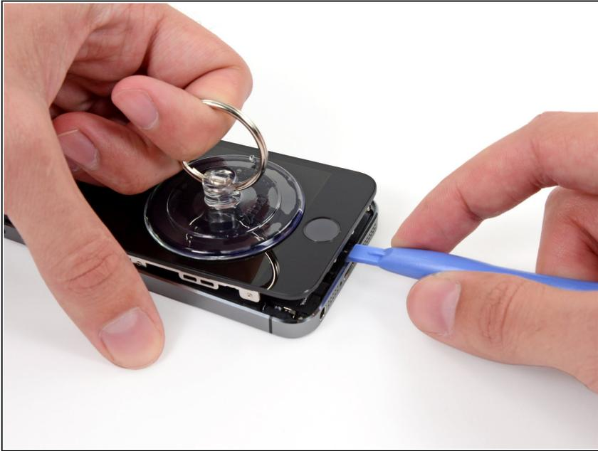
**⚠** L'écran est attaché avec des clips et plusieurs câbles plats le rattachent au reste du téléphone. Votre but ici, c'est de desserrer les clips et **d'ouvrir le téléphone juste assez pour déconnecter les câbles.**
