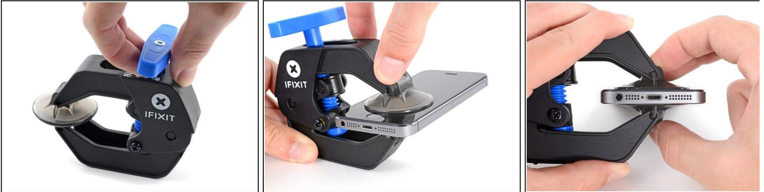
**i** Les deux étapes suivantes montrent comment utiliser l'Anti-Clamp, un outil conçu pour faciliter la procédure d'ouverture. **Si vous n'utilisez pas l'Anti-Clamp, sautez ces deux étapes pour une autre méthode.**
