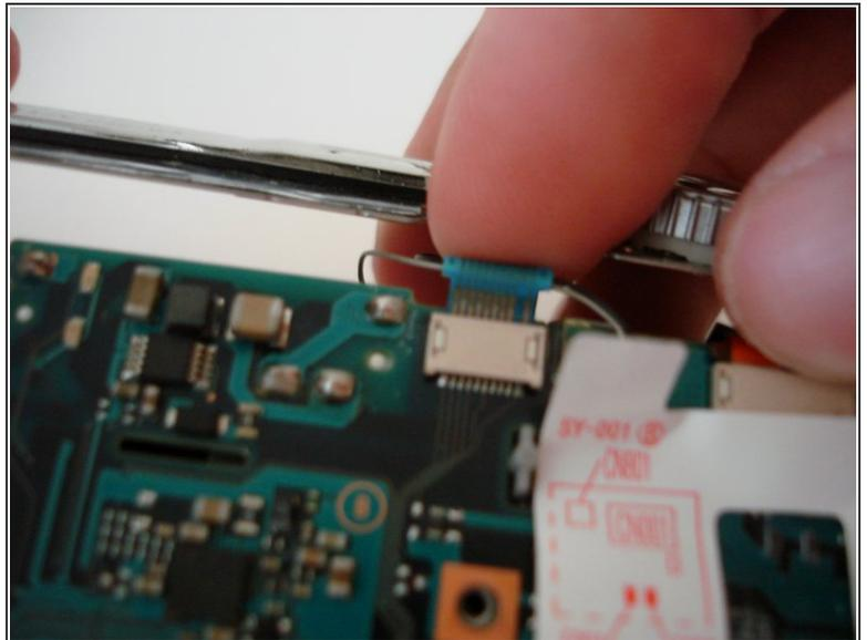
**⚠ Avertissement: Choc électrique** À partir de ce moment, tenez **UNIQUEMENT** la caméra par les bords chromés. Les condensateurs stockent la charge électrique même si les batteries sont retirées.
