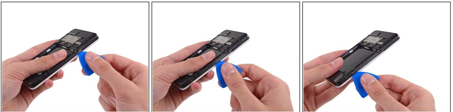
**i** Le châssis central est fixé à l'écran complet par plusieurs petits clips en plastique.
