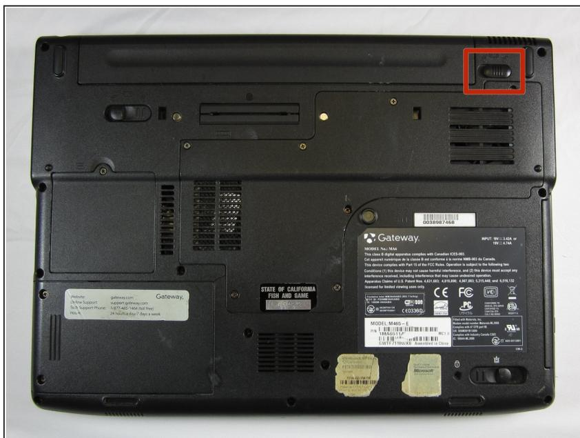
**⚠** Pour éviter tout dommage, soyez sûr que l'ordinateur portable est débranché avant de retirer la batterie.
