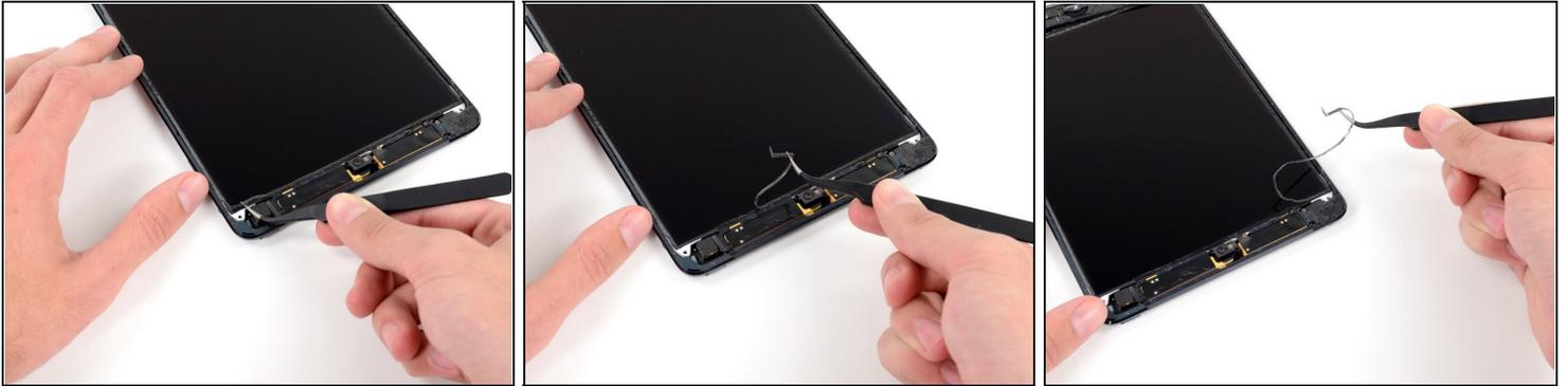
① Une mince bande de mousse autocollante sur le cadre du LCD recouvre une bande d'adhésif reliant l'écran LCD au panneau en dessous. Pour continuer, vous devrez déchirer et décoller un peu cette bande de mousse pour accéder à l'adhésif caché en dessous.
