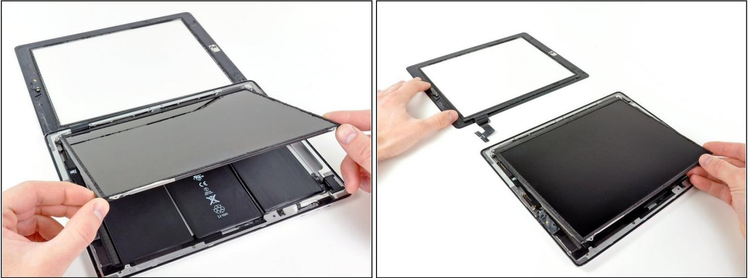
ⓘ Pour retirer l'ensemble du panneau frontal, il faut que la nappe coulisse entre le boîtier et le LCD. Vous devez déplacer le LCD pour avoir plus de place.
