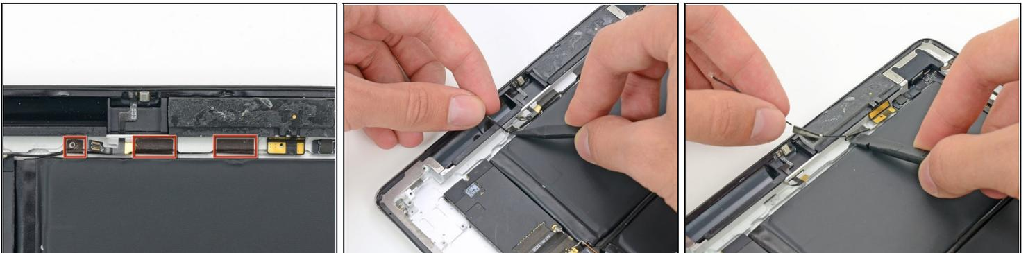
**⚠ Dans cette étape, vous retirerez les trois morceaux de ruban adhésif, fixant le câble de l'antenne cellulaire droite à la coque arrière.**
