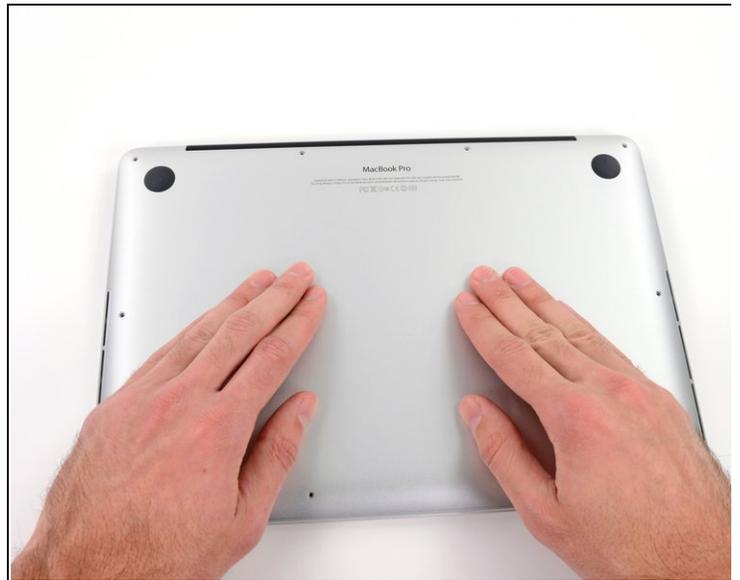
**i** Le boîtier inférieur est attaché au boîtier supérieur par deux attaches en plastique au milieu.
