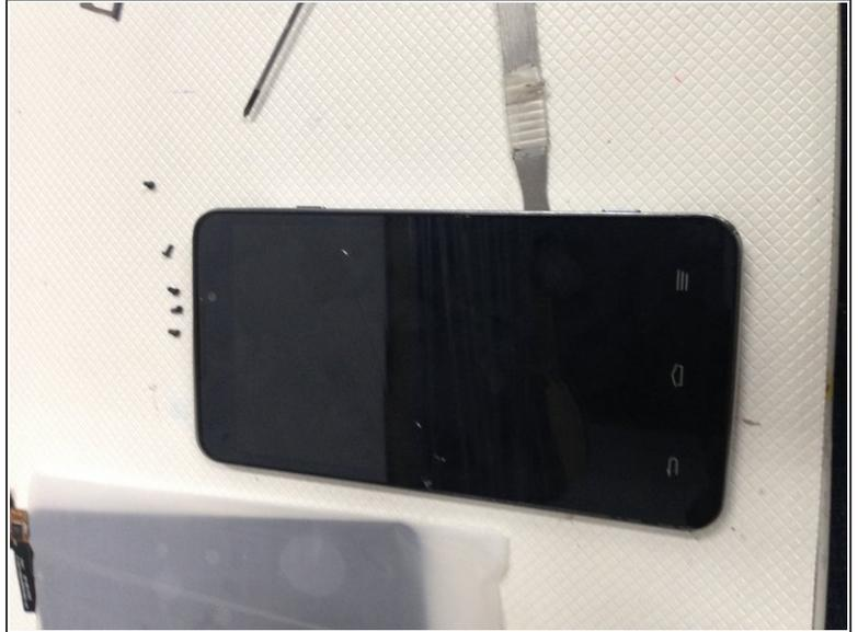
**⚠ AVEC UN PISTOLET CHAUFFANT, CHAUFFEZ L'ARRIÈRE ET L'AVANT POUR ENLEVER LA COLLE PLUS FACILEMENT**
